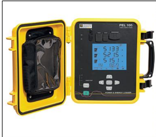
Figura 104. Equipo AEMC, PEL 105, utilizado en mediciones realizadas en niveles 7, 12, y 15
