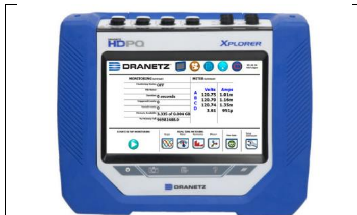
Figura 103. Equipo Dranetz HD PQ, utilizado en salidas de transformadores n°1 y 2 de subestación, (PCC) y otros ramales importantes
