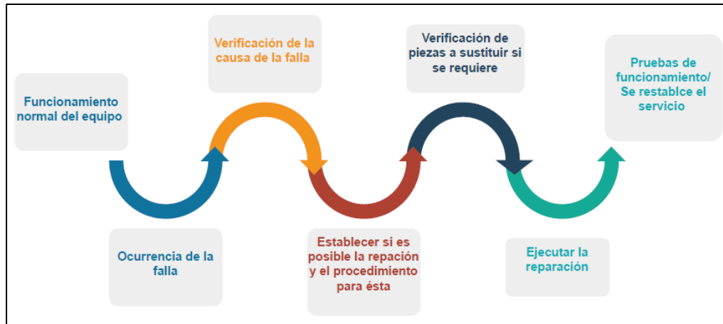
Figura 3. Flujo de actividades al realizar mantenimiento correctivo
