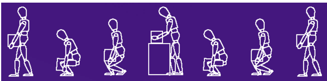
Figura 34. Levantamiento de cargas
