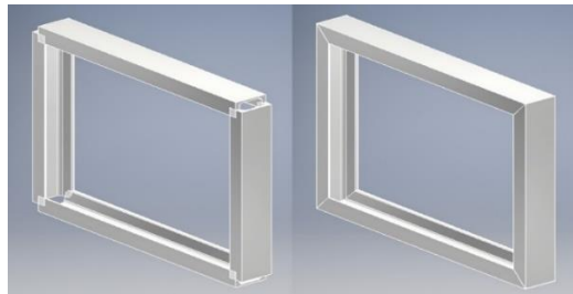
Figura 66. Antes y después de aplicar bisel a la estructura
