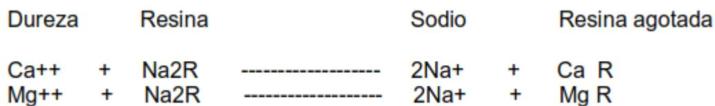
Para regenerar el suavizador, una solución fuerte de salmuera es usada. La solución fuerte de salmuera forzará al calcio y al magnesio de regreso a la solución. Los cationes de sodio se adhieren a la resina para que se mantenga eléctricamente neutra.
