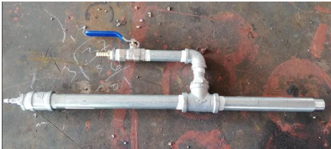
Figura 33. Prototipo de quemador desarrollado
