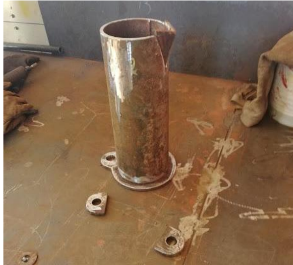
Figura 24. Construcción del crisol
