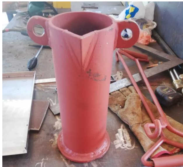
Figura 25. Crisol listo para operación
