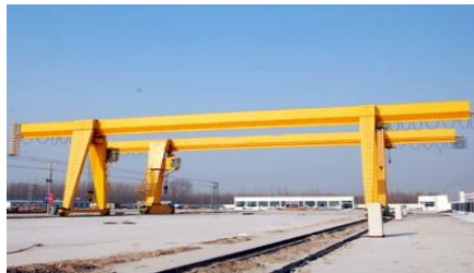
Figura 5. Puente grúa pórtico
