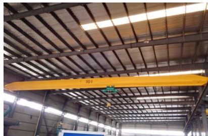
Figura 4. Puente grúa monorraíl
