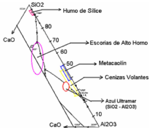
Figura 3. Diagrama de fase CaO – SiO 2 – Al 2 O 3 , localización de materiales puzolánicos
