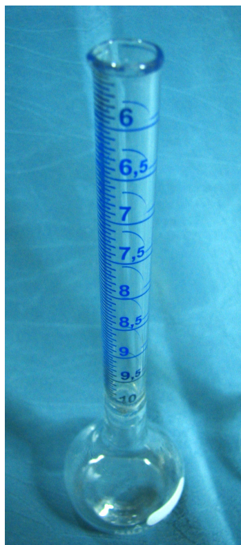
Figura 21. Fotografía de matraz de LeChatelier especial utilizado
