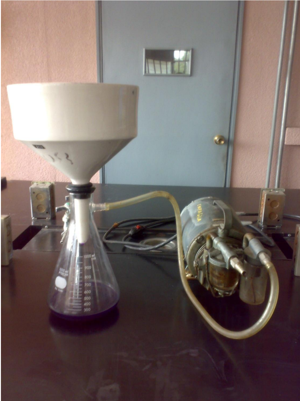
Figura 66. Equipo de filtración
