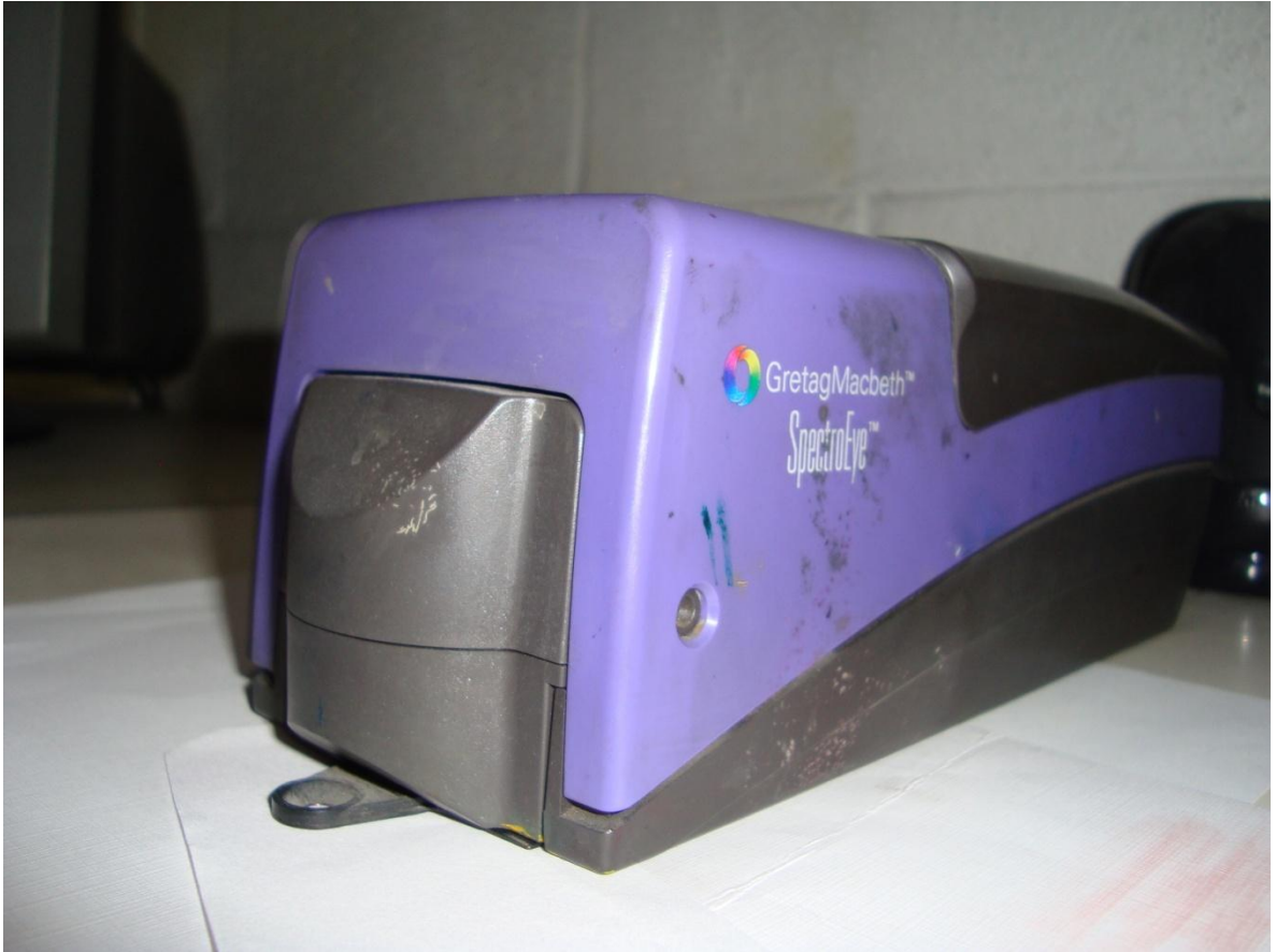
Figura 71. Equipo de medición de coordenadas de color Gretag Macbeth.
