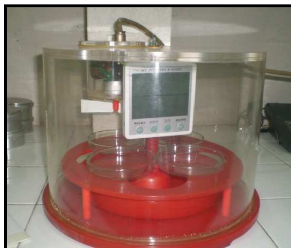
Figura 13. Montaje de equipo para Deshidratación Osmótica en atmósfera controlada
