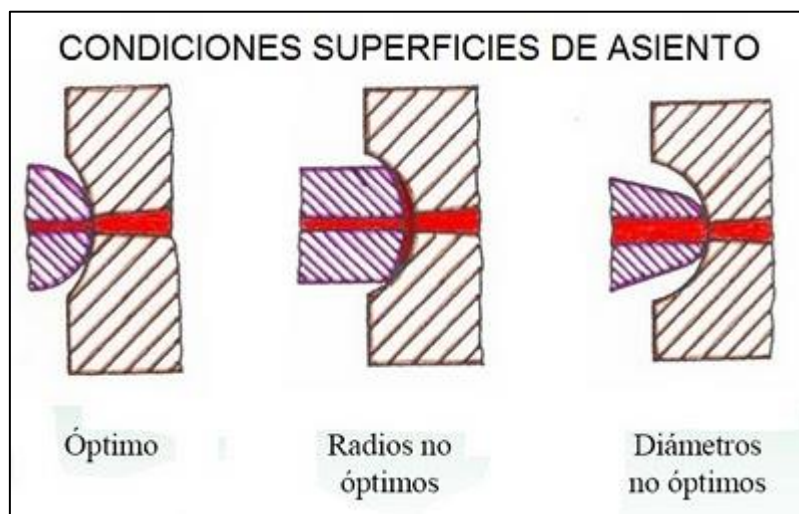
Figura 4. Tipos de contacto de boquillas de inyección
