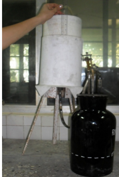
Figura 19. Medición de altura de biogás producido en el reactor de climatización
