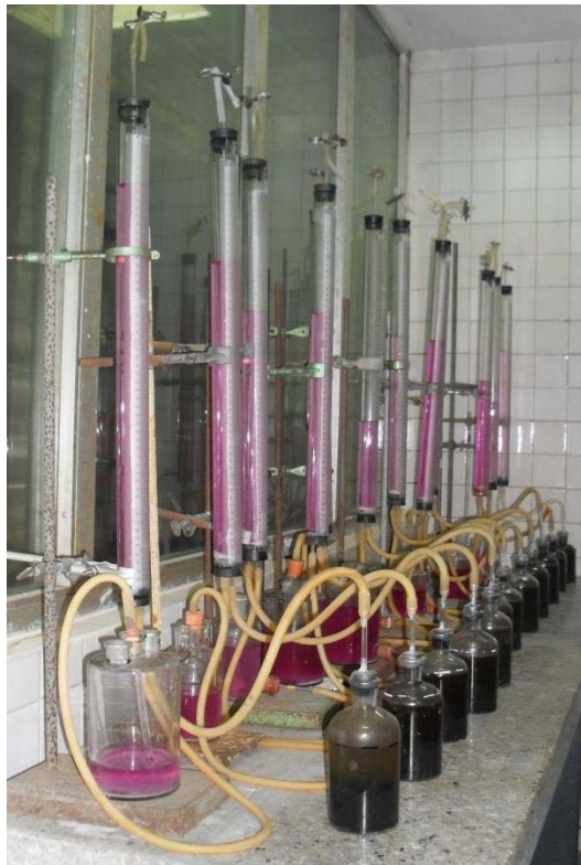
Figura 16. Montaje de reactores
