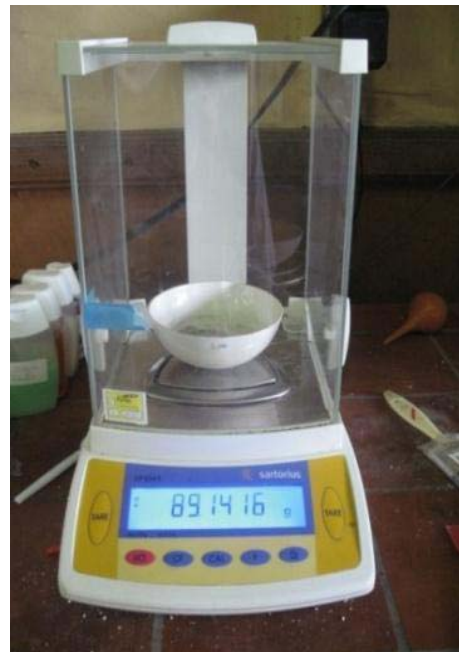
Figura 14. Balanza analítica modelo CP 3245 SARTORIUS
