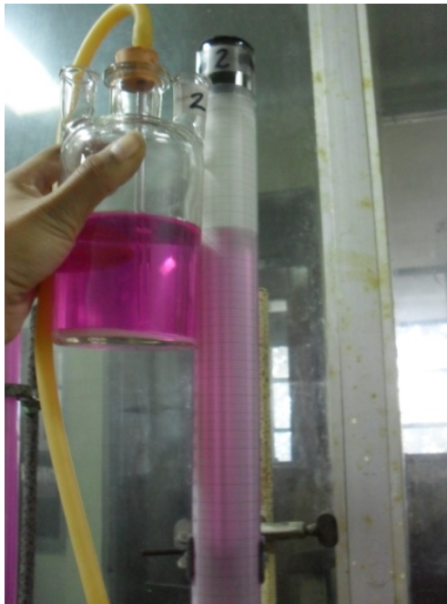
Figura 22. Medición de altura de la columna colectora de biogás
