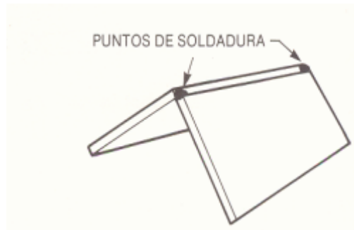
Figura 41. Colocación provisoria de dos piezas en junta de esquina
