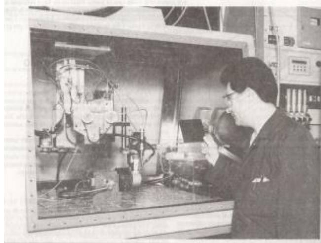
Figura 18. Cámara de atmósfera controlada empleada para soldadura tig en metales reactivos
