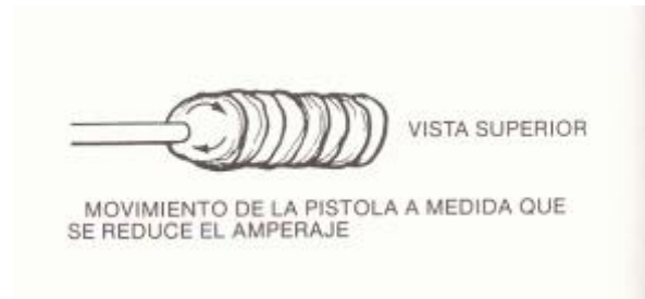
Figura 76. Llenado de cráter en la terminación del cordón de soldadura
