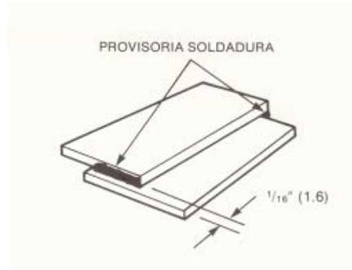
Figura 61. Colocación de piezas de trabajo en posición para soldadura de filete de junta de traslape
