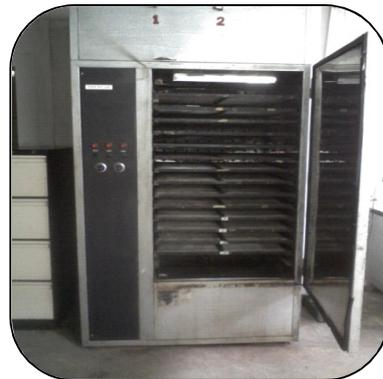
**3.6.2.2 Secador con sistema de vacío:** capacidad de 3 bandejas sin malla. Se utilizará una temperatura promedio de 40°C.
