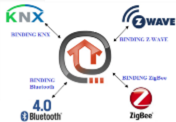
Imagen 2: Funcionalidad de Software OpenHAB con diferentes tecnologías, Fuente: Panel Sistemas
