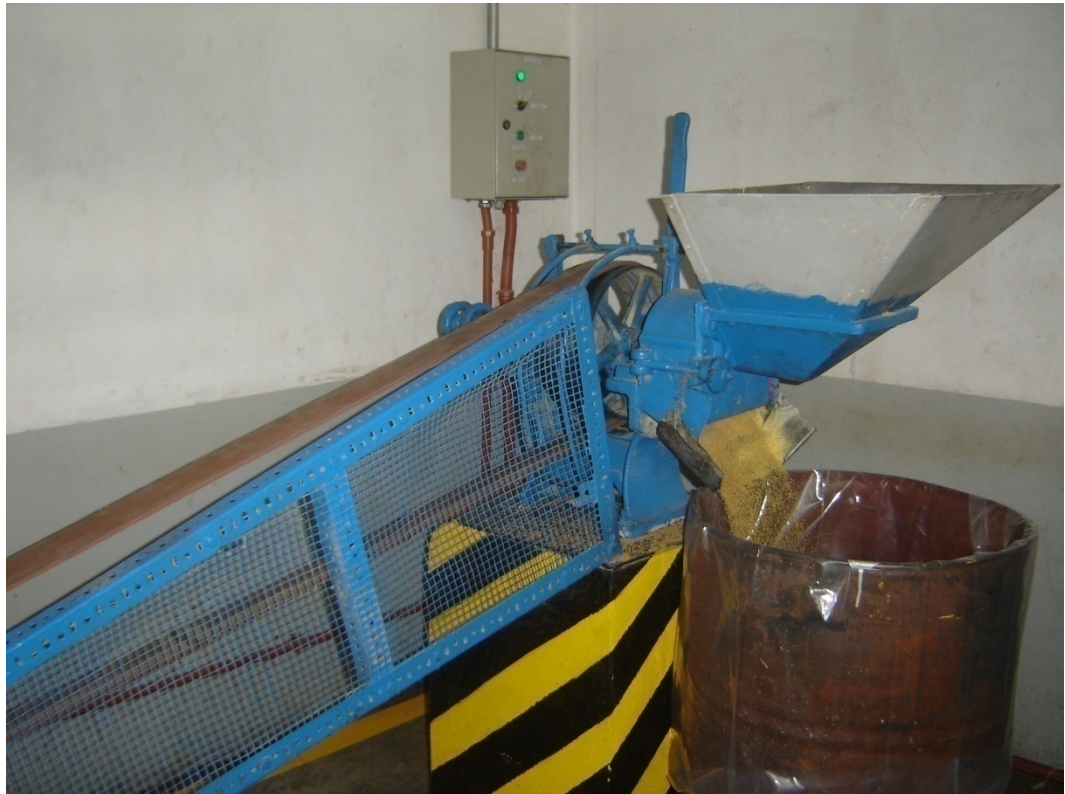
Figura 17. Fotografía de molino industrial para obtener harinas
