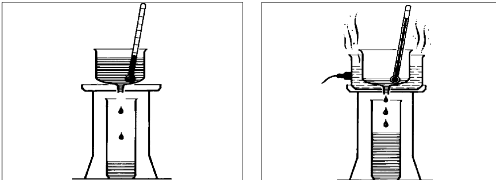
Figura 10. Viscosidad en fluidos con distinta temperatura
