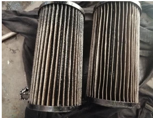
Figura 19. Filtros primarios y secundarios de bomba de empuje
