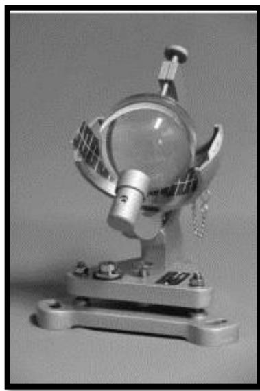
*Nota.* El heliógrafo Campbell-Stockes es un dispositivo meteorológico que utiliza una lente para concentrar la luz solar. Obtenido de A. Müller (2013). *Heliógrafos Tipo Campbell-Stokes.* R. FUESS.
