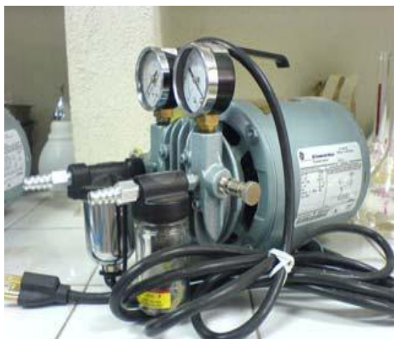
Figura 16. Bomba de vacío
