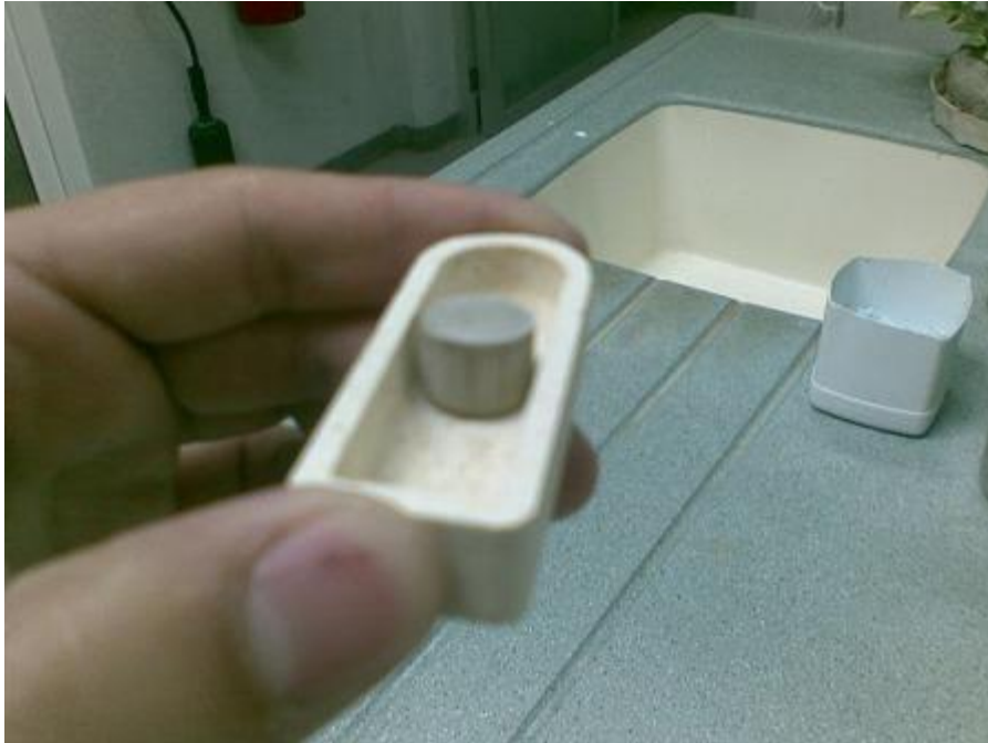
Figura 25. Crisol cerámico incandescente sacado de la mufla tras una prueba de quemado
