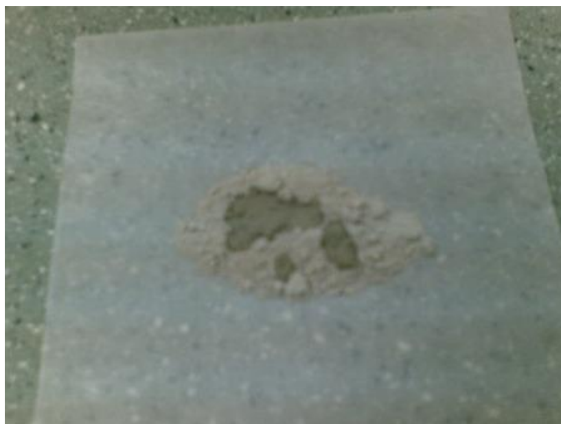
Figura 21. Mezcla de etanol y harina preparada para las pastillas prensadas
