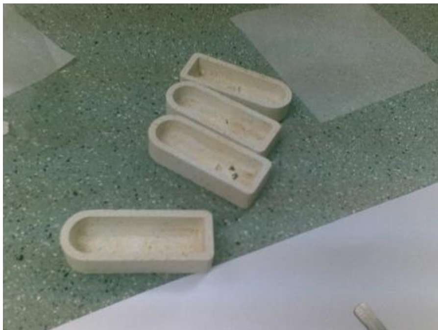
Figura 23. Crisoles cerámicos usados para las pruebas de quemado
