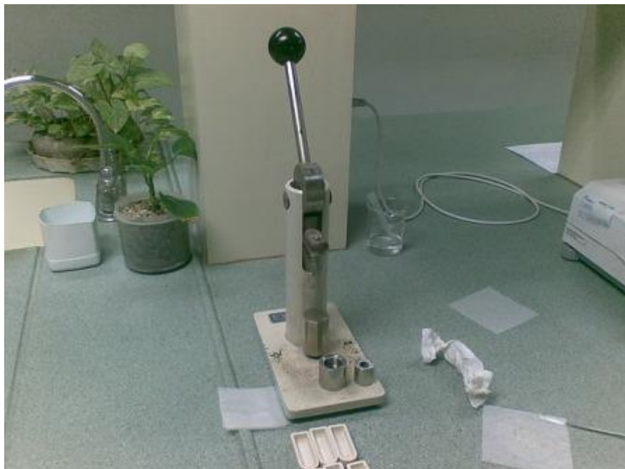
Figura 17. Prensa para forjar pastillas de harina cruda con etanol
