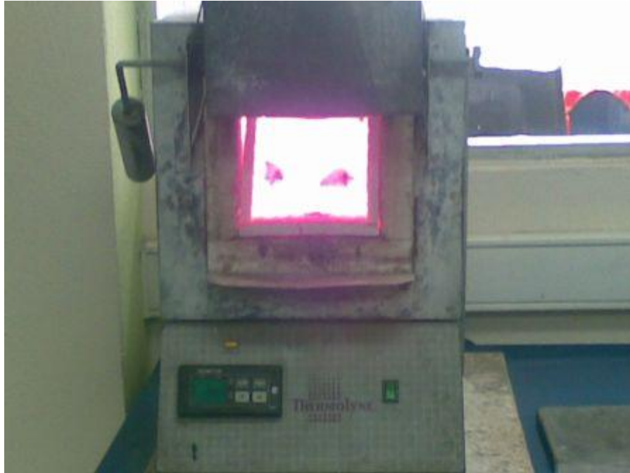
Figura 16. Mufla para pruebas de calcinación – clinkerización
