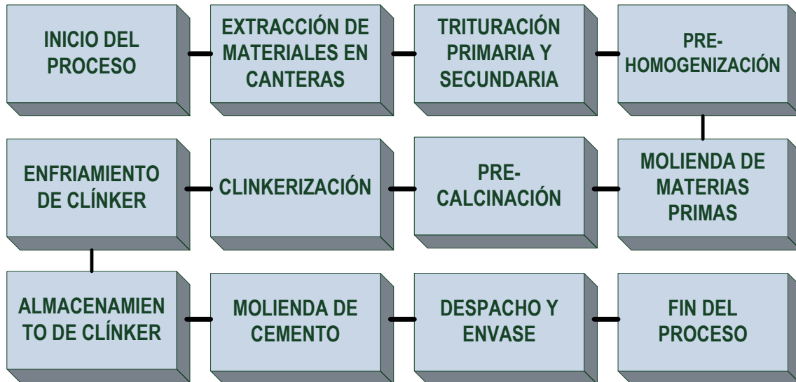
Figura 1. Diagrama esquemático de la fabricación del cemento
