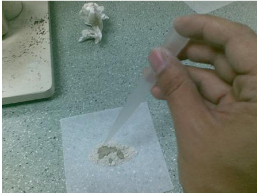
Figura 21. Mezcla de etanol y harina preparada para las pastillas prensadas
