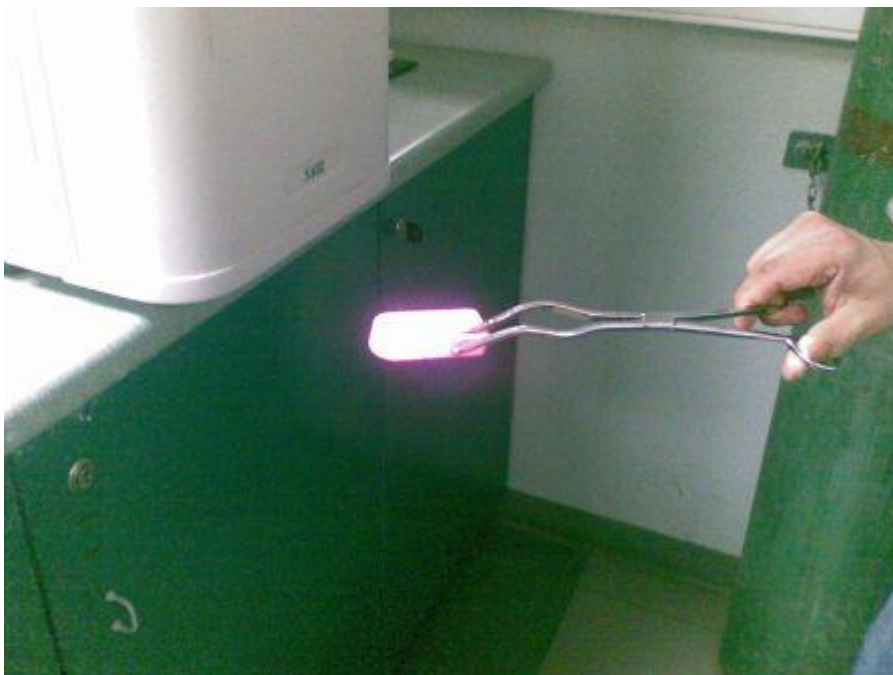
Figura 25. Crisol cerámico incandescente sacado de la mufla tras una prueba de quemado
