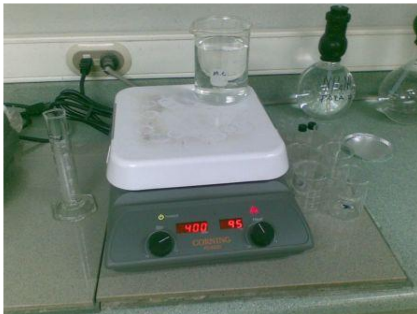
Figura 27. Cristalería y equipos varios usados en la prueba de cal libre ASTM C114
