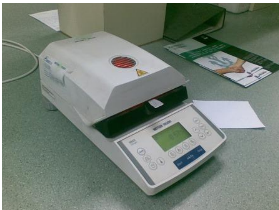
Figura 29. Desecadora de muestras usada para remoción de humedad en harina cruda
