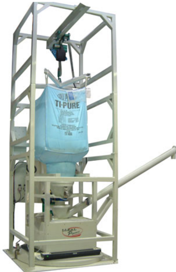
Figura 5. Sistema de envasado de Big Bag
