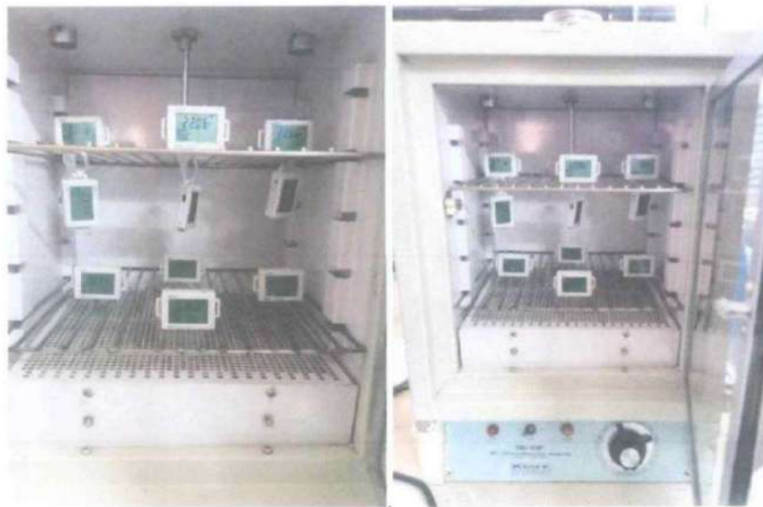
Imagen 4: Distribución de sensores de temperatura en incubadora del área de microbiología de Ingenio Santa Ana.
