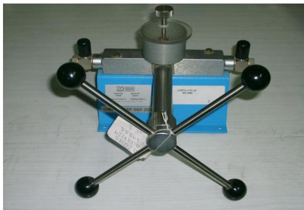
Figura 7. Bomba para proveer presión hidráulica
