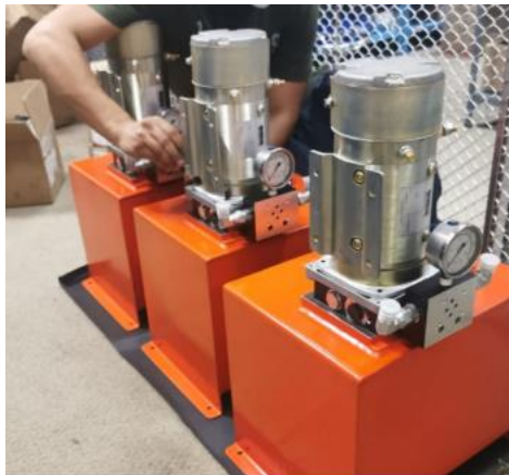
Figura 116. Montaje del motor eléctrico
