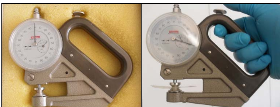
FIGURA 10. Pie de rey marca Käfer utilizado para medir el espesor de la membrana
