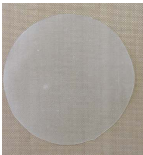
FIGURA 9. Membrana de poli(óxido de etileno-co-epiclorhidrina) 94/6 en círculo de 4.7 cm de diámetro
