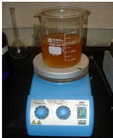
Figura 27. Detalle de la unidad de secado de biodiesel
