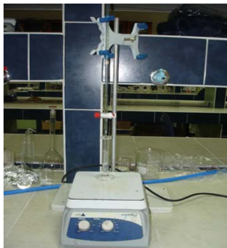
Figura 28. Detalle de la unidad utilizada para la titulación de las mezclas binarias a temperaturas ambiente
