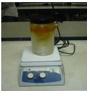
Figura 25. Detalle de la unidad de lavado de biodiesel
