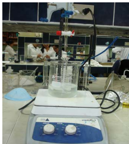
Figura 28. Detalle de la unidad utilizada para la titulación de las mezclas binarias a temperaturas ambiente
