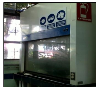
Figura 49. Campana de extracción
