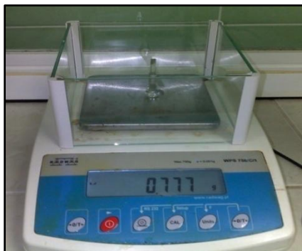
Figura 57. Medición de densidad con micropicnómetro y balanza analítica
