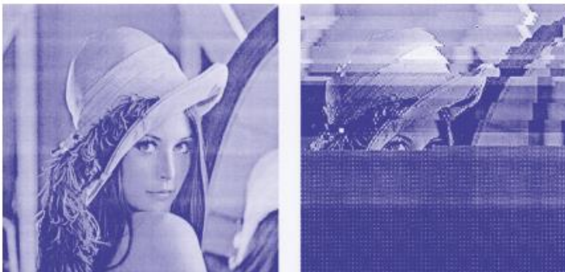
Figura 10. Efectos de los errores en la transmisión de imágenes comprimidas
