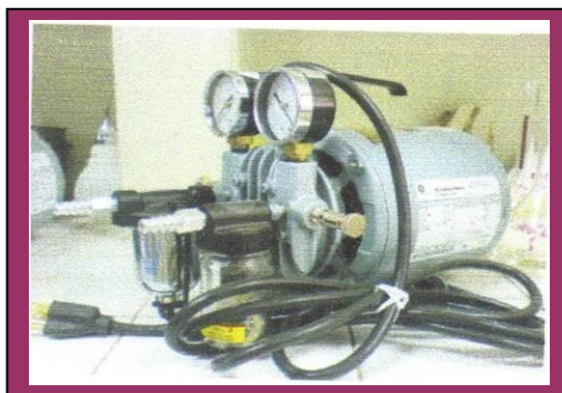
Figura 23. Bomba de vacío
