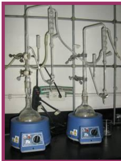
Figura 42. Equipo por arrastre de vapor
