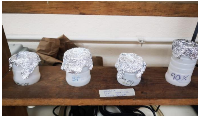
Figura 7. Sistema de lixiviado para método de mejor solvente
