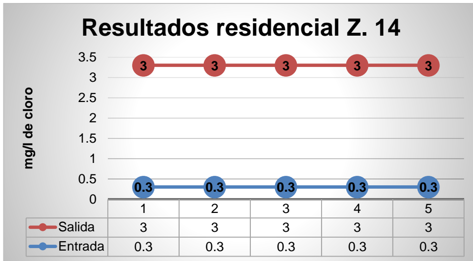
Figura 8. Medición de cloro residual entrada – salida residencial zona 14
