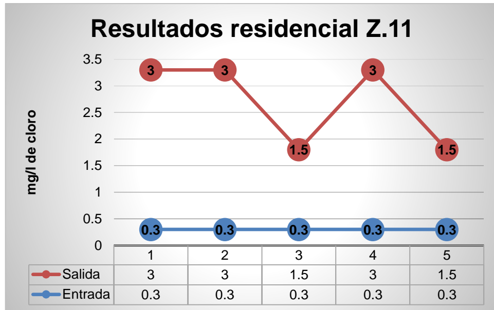
Figura 7. Medición de cloro residual entrada – salida residencial zona 11
