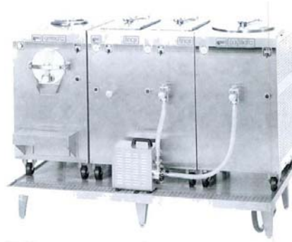
Figura 1. Esquema de equipo de pasteurización/homogenización mezcla para helado
