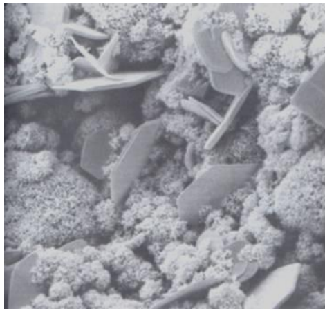
Figura 13. Pasta de cemento hidratada: \text{Ca}(\text{OH})_2 y C-S-H
