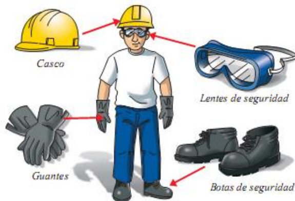
Figura 23. Equipo de protección personal exigido en subestaciones
