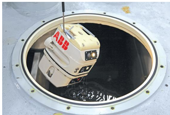
Figura 20. Boroscopio TXPLORE saliendo de transformador
