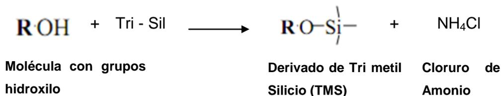
Esta reacción da una perspectiva del actuar del Tri – Sil reactivo de Pierce. Con ello se tiene asegurado la caracterización de los azúcares correspondientes en las muestras problema por el análisis de cromatografía de gases y espectros de masa.
