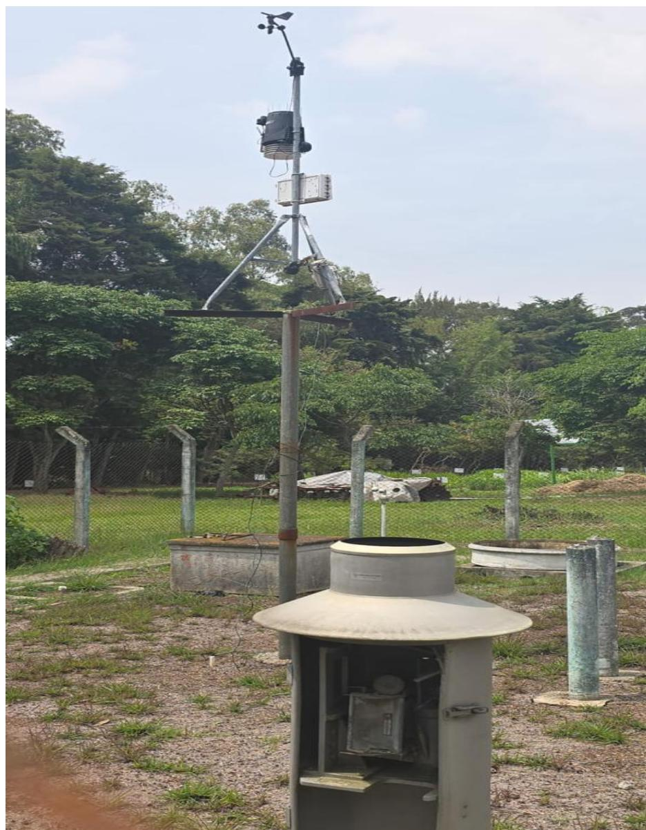
*Nota.* Estación meteorológica ubicada en el exterior del vivero, registra parámetros de radiación solar, temperatura, humedad relativa y velocidad del viento. Elaboración propia.
