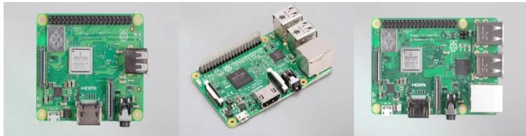
*Nota.* Es un conjunto de placas de ordenador de bajo costo que comparten características similares. Obtenido de Raspberry Pi (s.f.). *Raspberry Pi 3 Model A+ (izquierda), Raspberry Pi 3 Model B (centro) y Raspberry Pi 3 Model B+ (derecha)* (<https://www.raspberrypi.com/>). Consultado el 12 de marzo de 2024. De dominio público.
