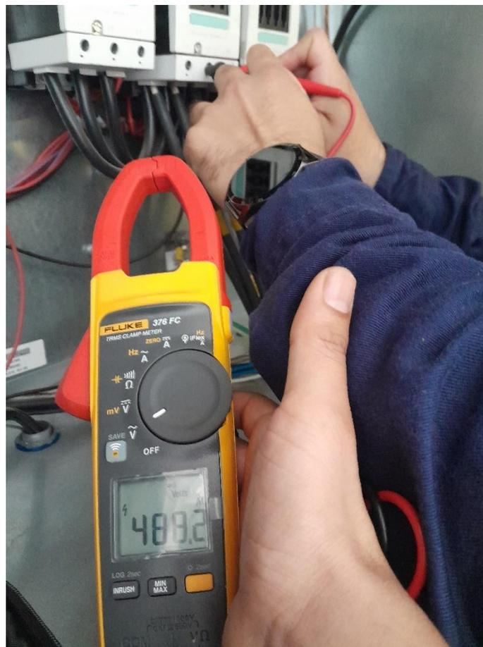
*Nota.* Toma de mediciones de voltaje de compresor. Elaboración propia.
