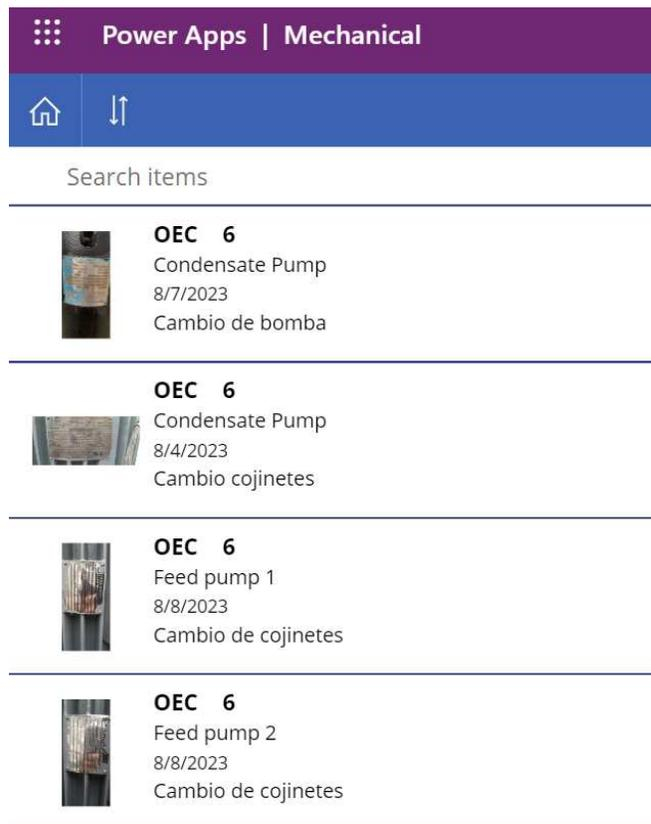
*Nota.* Detalle de apartado de búsqueda de registros en el control de mantenimiento. Elaboración propia, realizada con Power Apps.
