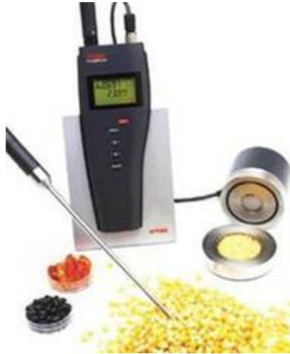
Figura .2 Medidor de humedad relativa
