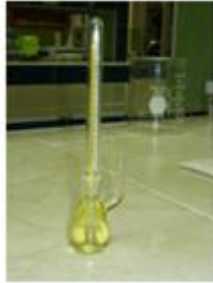
Figura 16. Picnómetro, instrumento de medición de la densidad
