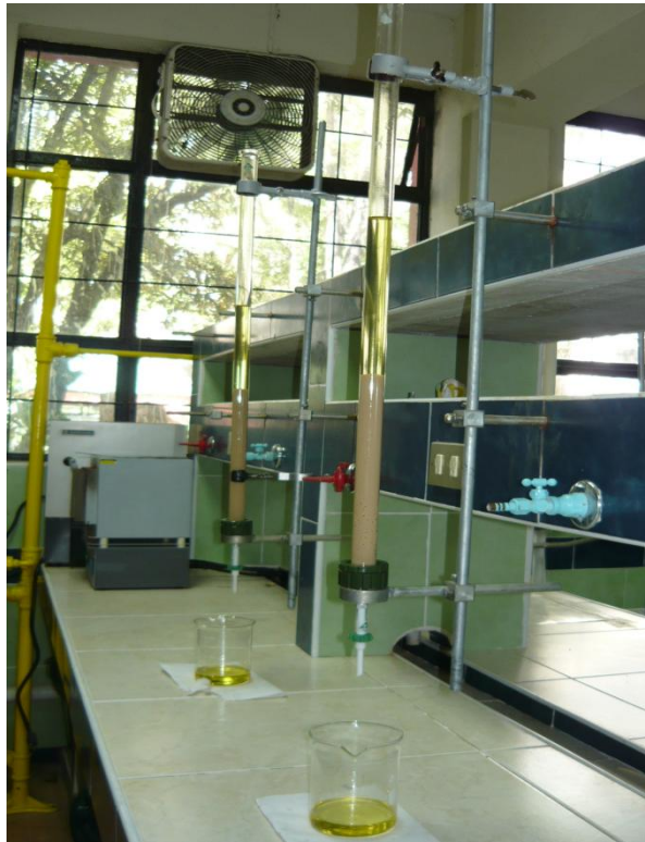
Figura 5. Columna de refino de biodiesel de la parte experimental (se realizaron 2 corridas a la vez)
