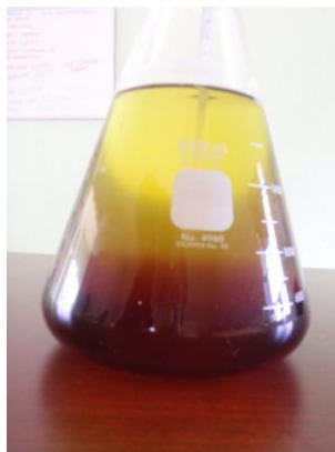
Figura 6. Elaboración de biodiesel, etapa de decantación
