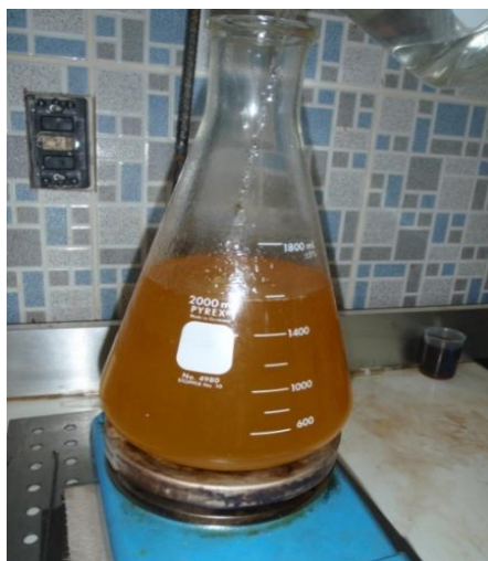
Figura 5. Elaboración de biodiesel, etapa de transesterificación
