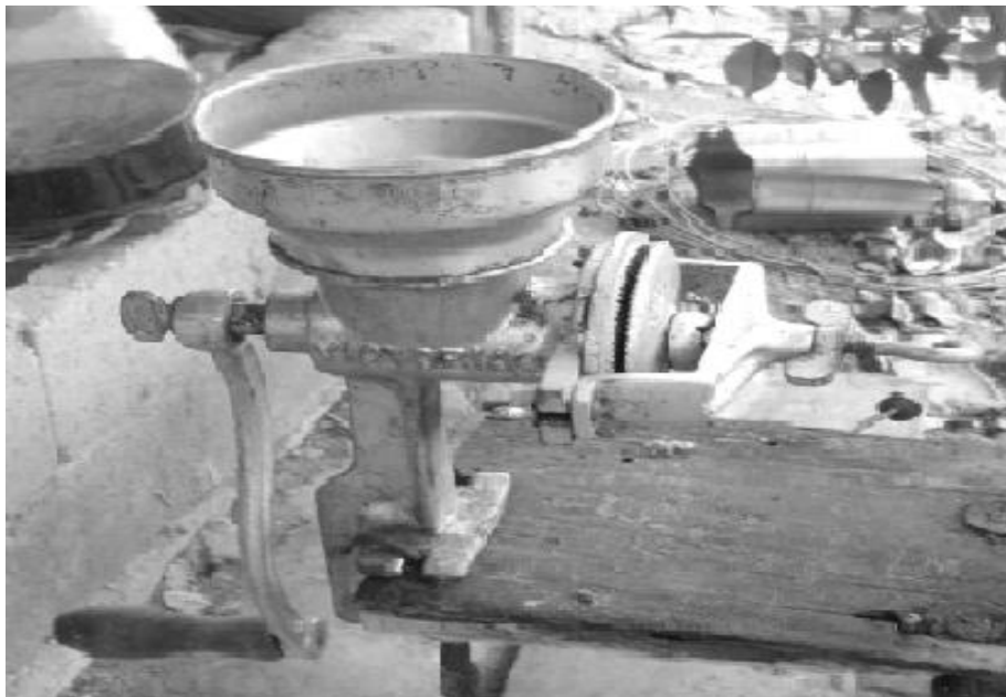
Figura 10. Equipo para molido del maní
