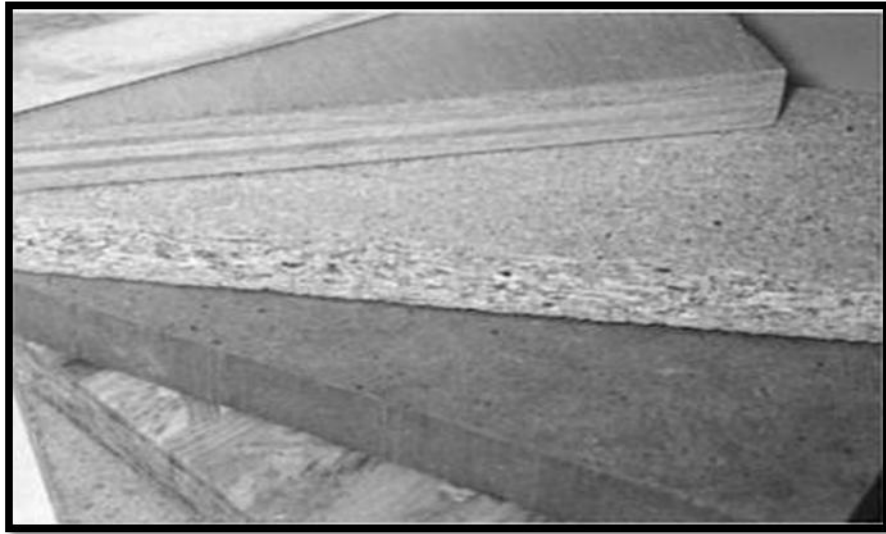
Figura 12. Tipos de aglomerados de madera
