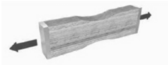
Figura 16. Prueba de tensión paralela a la superficie
