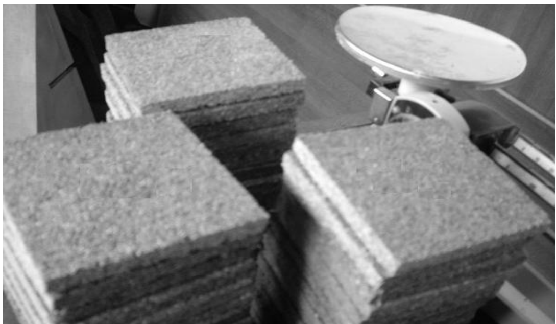
Figura 38. Paneles menores elaborados a partir de epicarpio de maní y acetato de polivinilo
