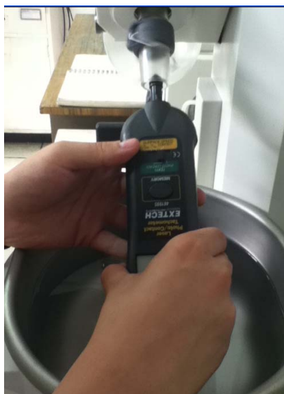
Figura 13. Calibración de rotación del matraz en revoluciones por minuto utilizando un tacómetro
