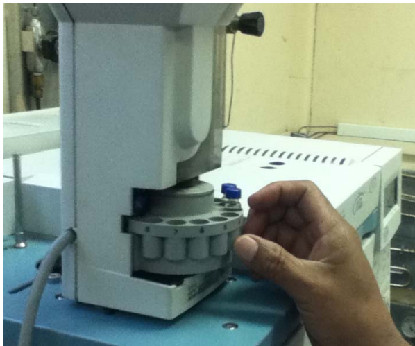
Figura 11. Metodología de colocación de viales
