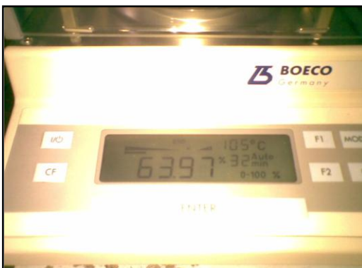
Figura 10. Determinación de la humedad del flavelo fresco
