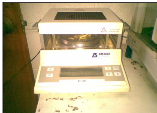
Figura 9. Determinación de la humedad del flavelo deshidratado
