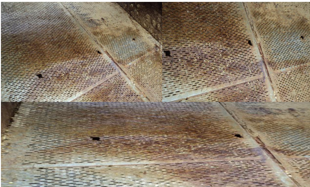
Figura 36. Condiciones desfavorable del tamizador
