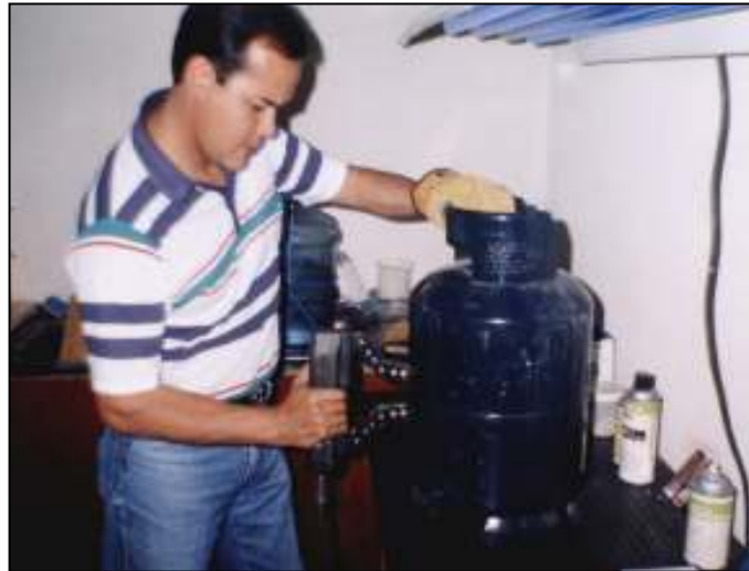
Figura 16. Inspección por partículas magnéticas
