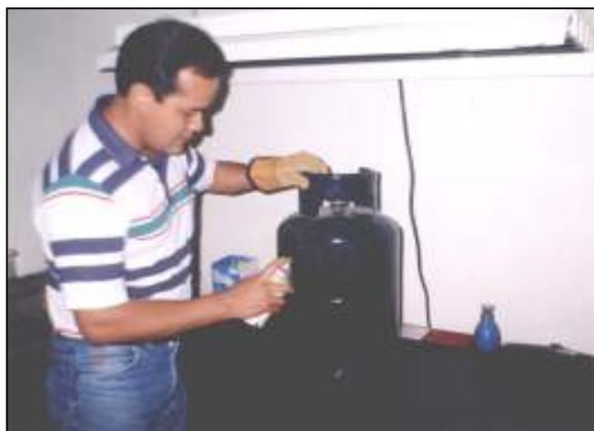
Figura 23. Inspección por líquidos penetrantes
