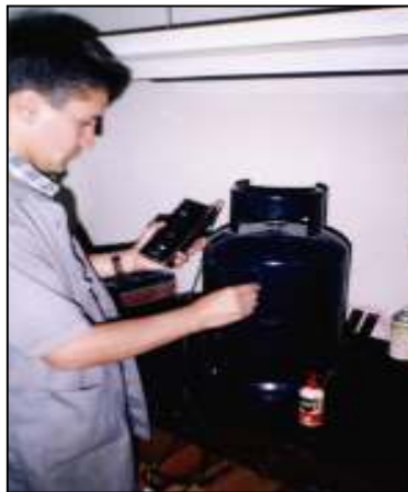
Figura 29. Medición de espesor por ultrasonido
