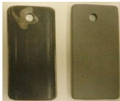
Figura 6. Acero sin tratamiento y posterior al sandblasting
