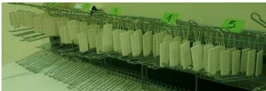
Figura 7. Batería de láminas recubiertas, mezclas uno a cinco
