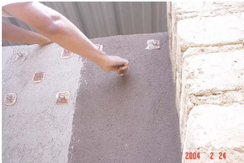
Figura 13. Fotografía de muestra para ensayo de arrancamiento de revestimientos
