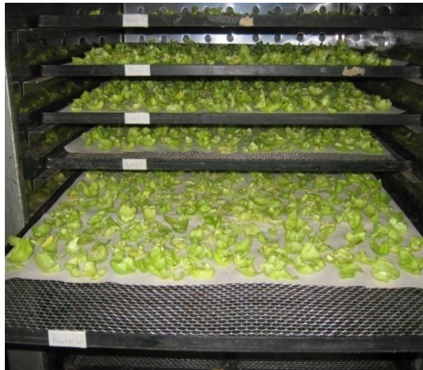
Figura 5. Secado de chile chamborote en un secador de bandejas eléctrico
