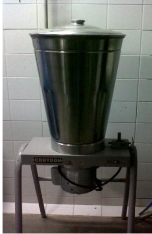
Figura 13. Licadora industrial para la molienda de materia prima
