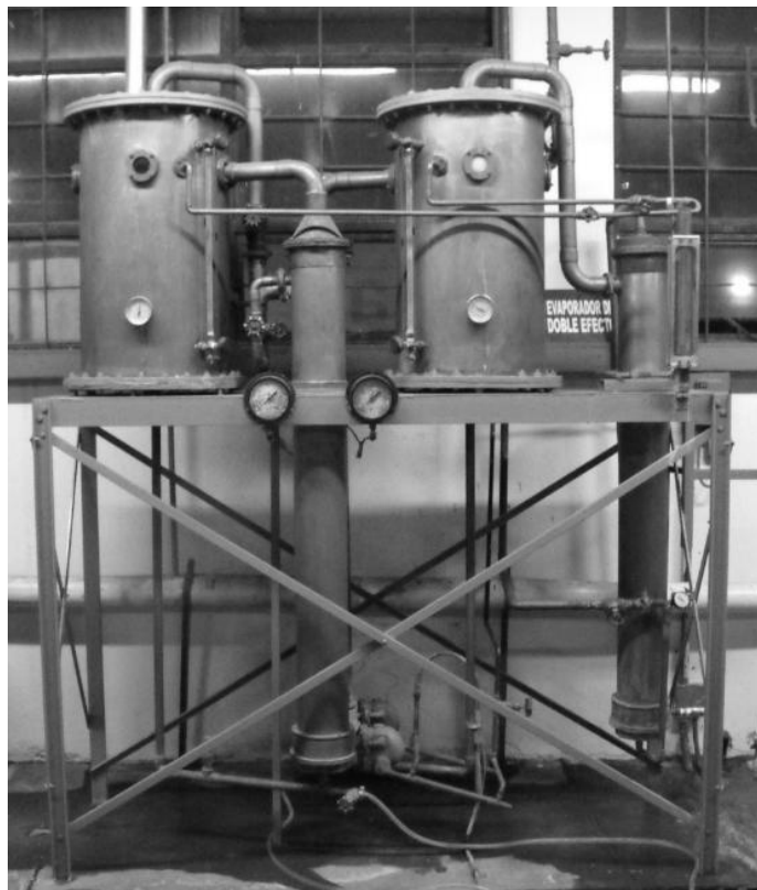
Figura 12. Unidad de evaporación doble efecto
