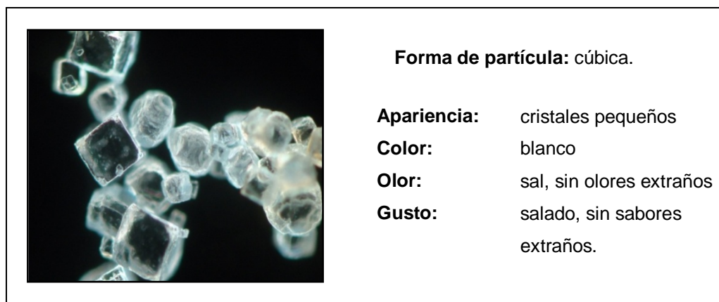
Figura 60. Análisis de granulometría, para sal refinada yodada
