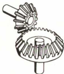
Figura 7. Ruedas cónicas con dientes rectos
